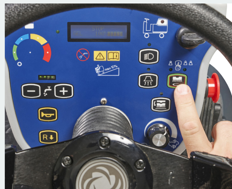
Børstehoved/sugefod sænkes automatisk, hvilket aflaster operatøren
